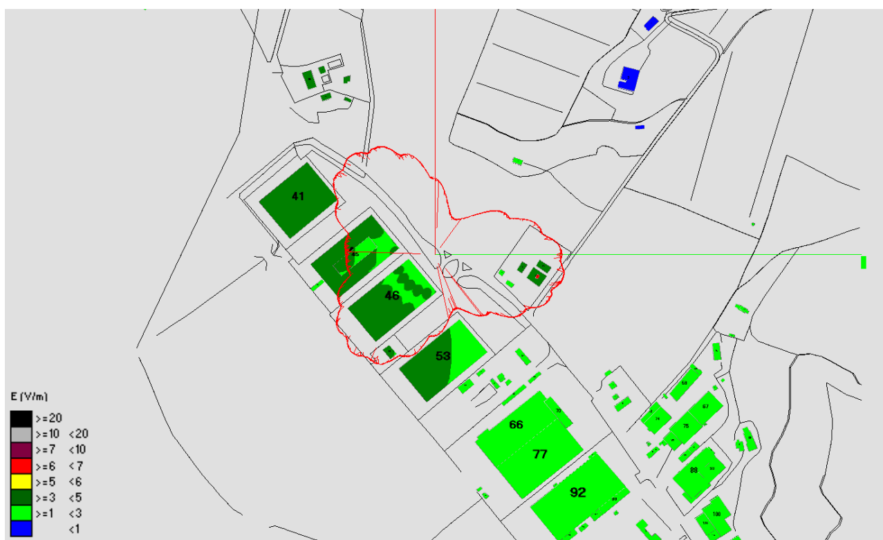
Fig. 28 Impatto elettromagnetico – Zona Area Via Caduti di Nassirya – Vista dall'alto
