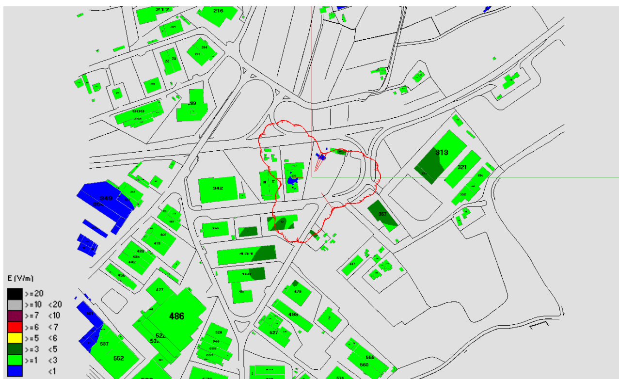
Fig. 33 Impatto elettromagnetico – Zona Area Parcheggio Std di Chiano-Via Collodi – Vista dall'alto
