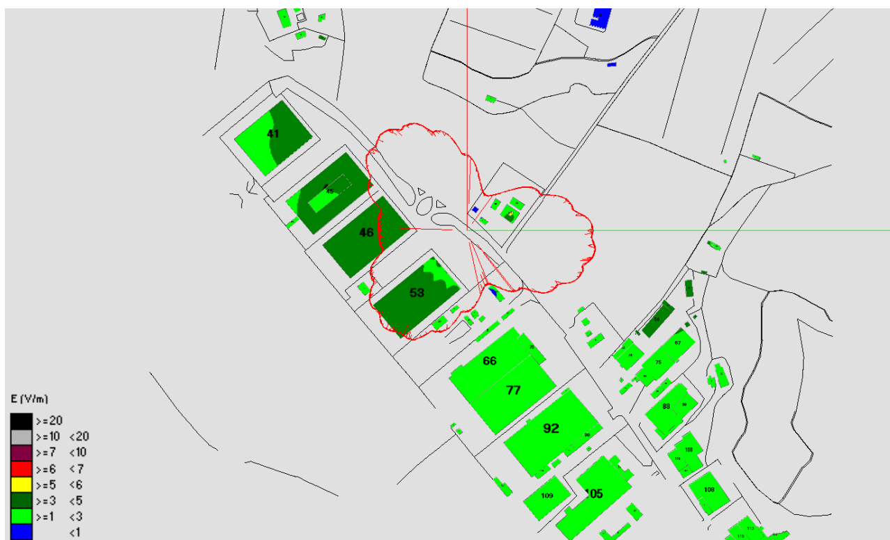
Fig. 23 Impatto elettromagnetico – Zona Area Parcheggio Via Pisana – Vista dall'alto
